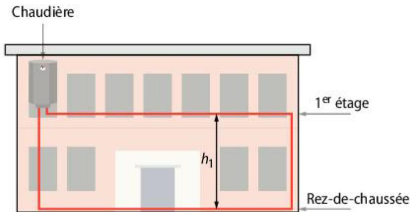
1. Calculer le diamètre  $d_0$  de la canalisation installée au rez-de-chaussée.
