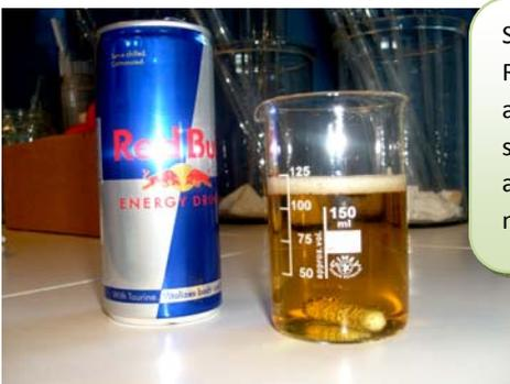
Solution de RED-BULL® après dégazage sur un agitateur magnétique
